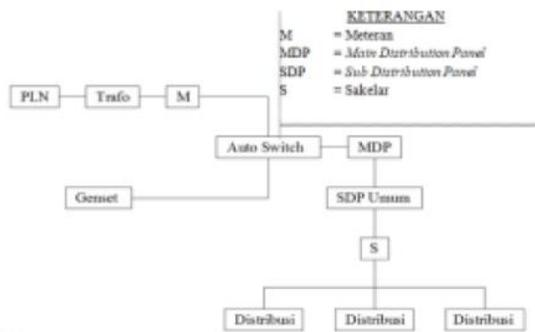
Gambar 4. Sistem Instalasi Listrik
