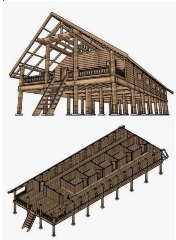
Gambar 5: Bentuk Bangunan Umah Pitu Ruang (Sumber: Analisis Bangunan UPR Linge/Toweren)
