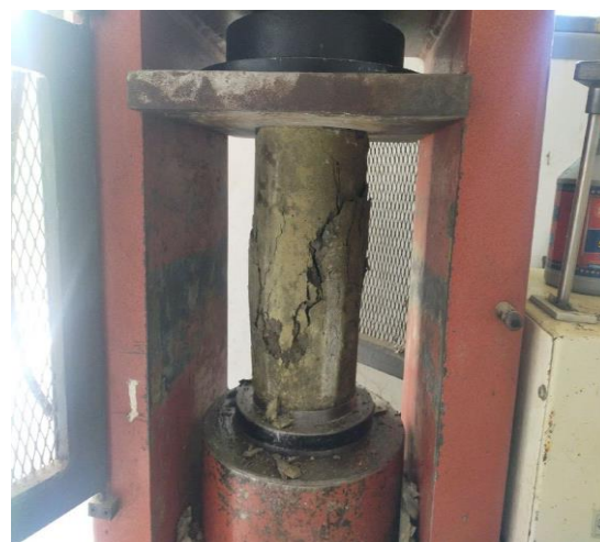
Gambar 3. Retak Vertikal Dari Ujung Ke Ujung Pada Beton Umur 7 Hari
