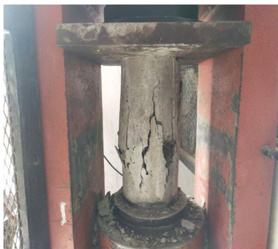
Gambar 4. Retak Kerucut dan Vertikal Pada Ujung Pada Beton Umur 28 Hari
